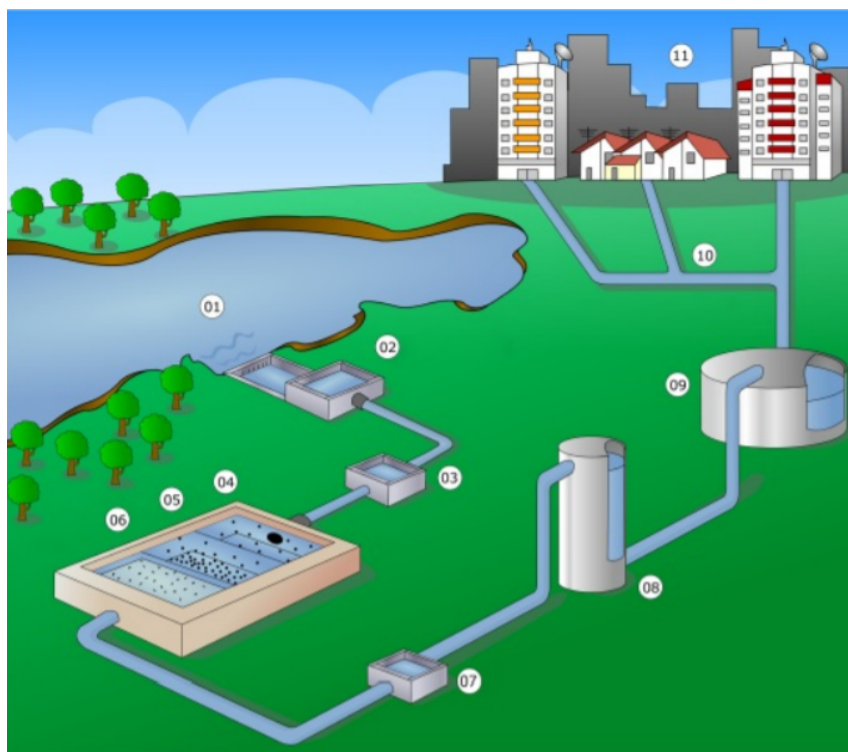
Figura 1 – Captação, tratamento e distribuição de água
